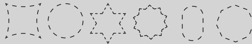
CleanAir produce jaulas filtrantes dependiendo de las necesidades específicas de sus clientes. Las secciones de estos productos varían en forma y tamaño. Estas secciones pueden ser rectangulares, redondas, romboidales, cuadradas, en forma de estrella u octogonales. La longitud de las jaulas es de hasta 7 m en una sola pieza. Sin embargo, puede ir más allá en el caso de dos a tres secciones y diámetros con el rango entre 80mm y 200mm.
