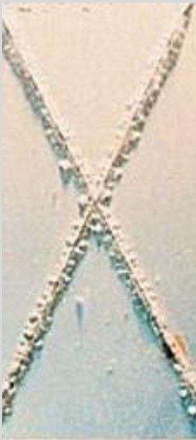
Corrosion après 1100 heures
