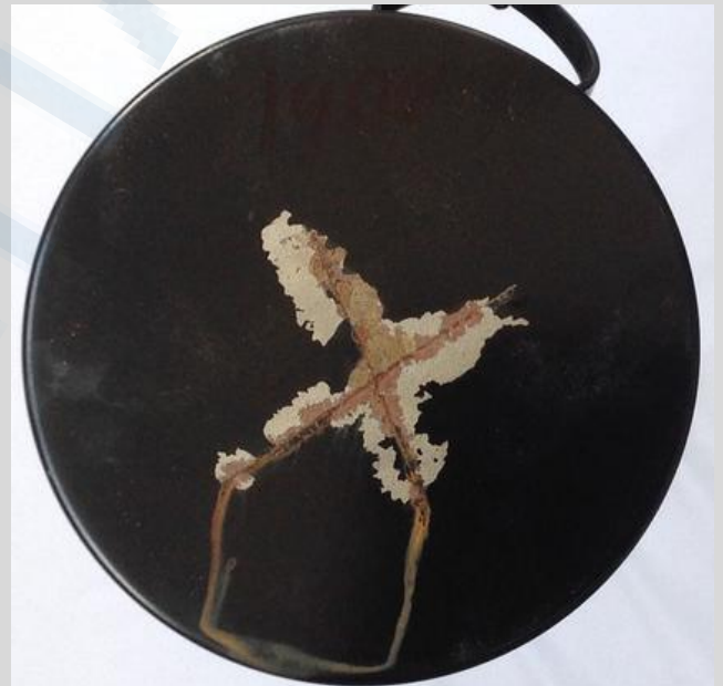
Corrosion après 1800 heures de test au brouillard salin.
