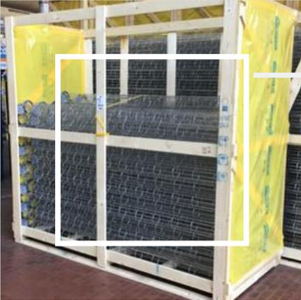
L'exposition des cages aux intempéries peut provoquer un phénomène d'oxydation généralisée à court terme.
