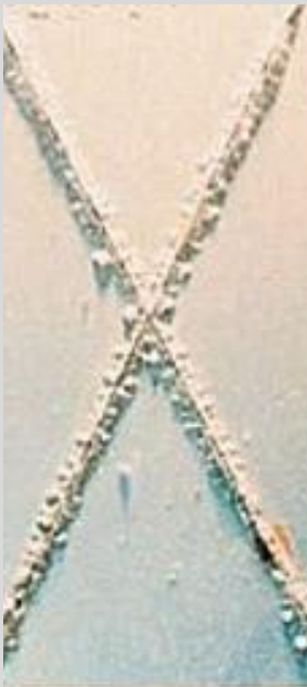
Corrosión después de 1100 Hrs
