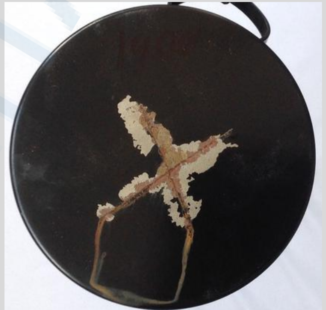
Corrosión después de 1800 horas de prueba en cámara de niebla salina.
