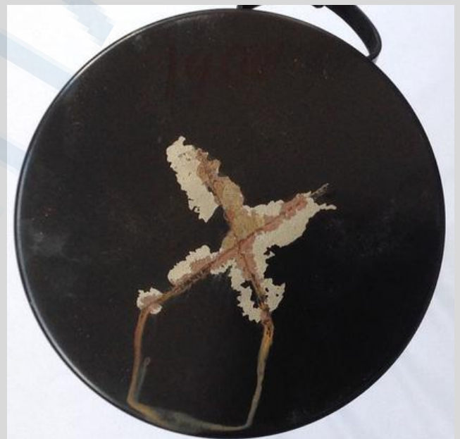
Corrosione dopo 1800 ore di test in camera a nebbia salina.
